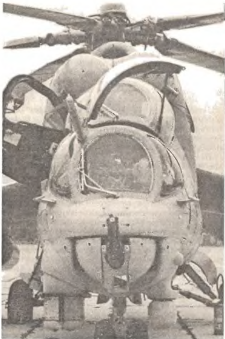
«Летающая БМП» Советской Армии — боевой вертолет Ми-24, больше известный как «крокодил». В его комплекс вооружений входил четырехствольный пулемет ЯКБ-12,7
