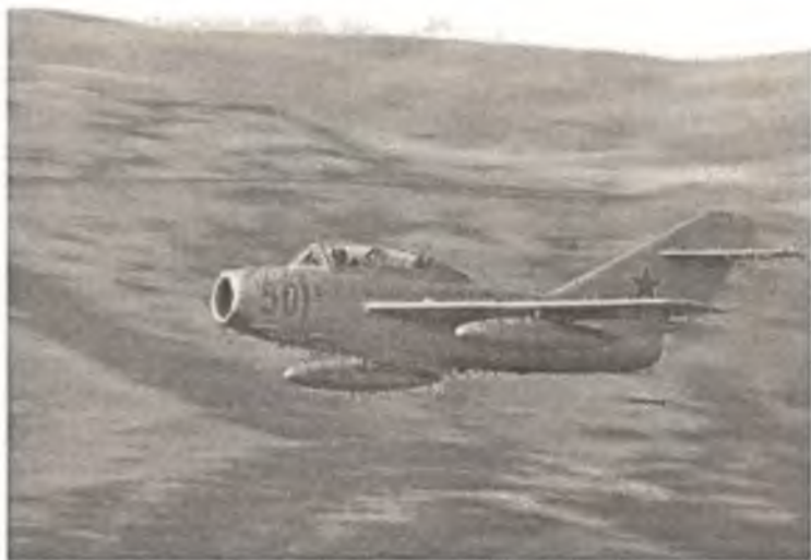
Увеличить радиус действия МиГ-15 позволяли подвесные топливные баки
