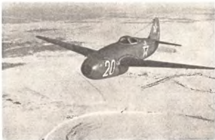
Истребитель Як-3 + реактивный двигатель Лито-004 = Як-15
