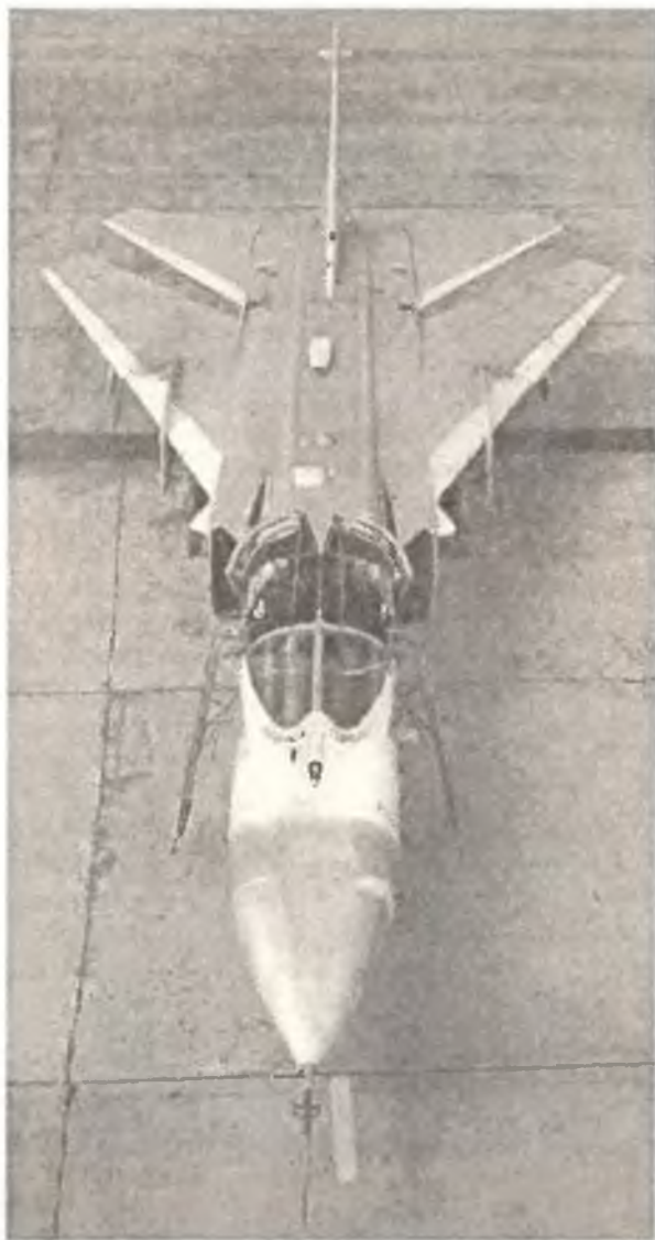
В конструкции фронтового бомбардировщика Су-24 конструкторы использовали модное в то время крыло с изменяемой геометрией
