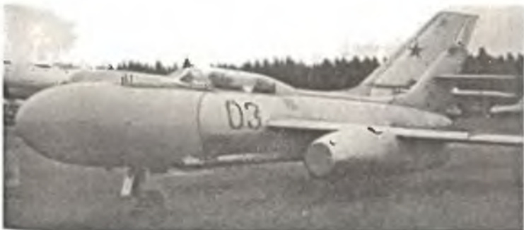
Истребитель-перехватчик Як-25 строился под радиолокационную станцию «Сокол»
